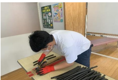
銅線への切り込み入れ
